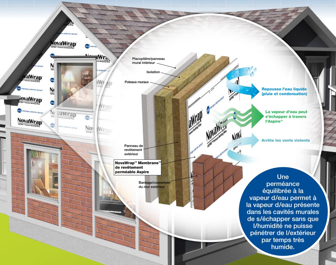
Une perméance équilibrée à la vapeur d'eau permet à la vapeur d'eau présente dans les cavités murales de s'échapper sans que l'humidité ne puisse pénétrer de l'extérieur par temps très humide.
